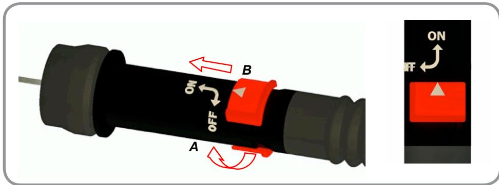
I cavi frizione “autoadjust” sono stati progettati per essere riutilizzati dopo un eventuale smontaggio dalla vettura. È possibile riutilizzare i cavi eseguendo il passaggio n° 3 in senso opposto e successivamente ripetendo tutti i passaggi dal n° 1 al n° 3.
